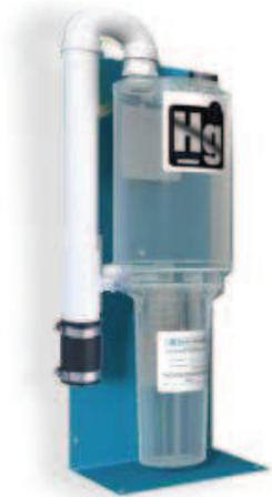
Este es un dispositivo de sedimentación, el cual recupera el 99 por ciento de la amalgama. Se instala con una conexión hacia el flujo de aire. En el momento que se va a retirar o pulir una amalgama, las partículas entran junto con el agua en el separador donde se dividen los sólidos de los líquidos, luego en el contenedor los sólidos entran al fondo, para que por medio de la gravedad los líquidos se
