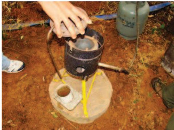
“Una retorta es un recipiente, con un mecanismo para abrir y cerrar el mismo, un tubo de salida en la cabeza del recipiente, es decir, en la tapa, y un cuello que apunta hacia abajo, similar a un tubo, que sirve como condensador. Se usa para destilar la amalgama y recuperar el mercurio condensado”.
