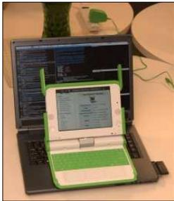
El computador está fabricado para personas de escasos recursos en todo el sentido de la palabra, desde el monto de compra hasta el consumo. El computador consume como máximo 2 watts por hora de uso. A diferencia de una computadora portátil convencional, este equipo informático tiene un diseño para que el niño pueda manipularlo a plena luz del día sin que tenga distorsión.
