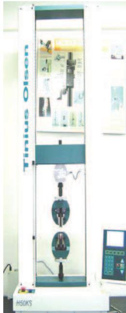
**Figura N1:** Máquina de tracción Tinius Olsen
